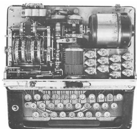
Рисунок 9 – шифровальная машина К-37 «Кристалл»
